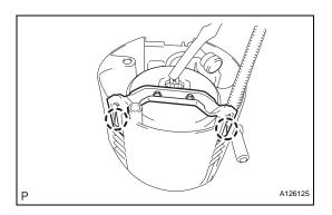
(d) Detach the 2 claws and remove the sub-tank.
