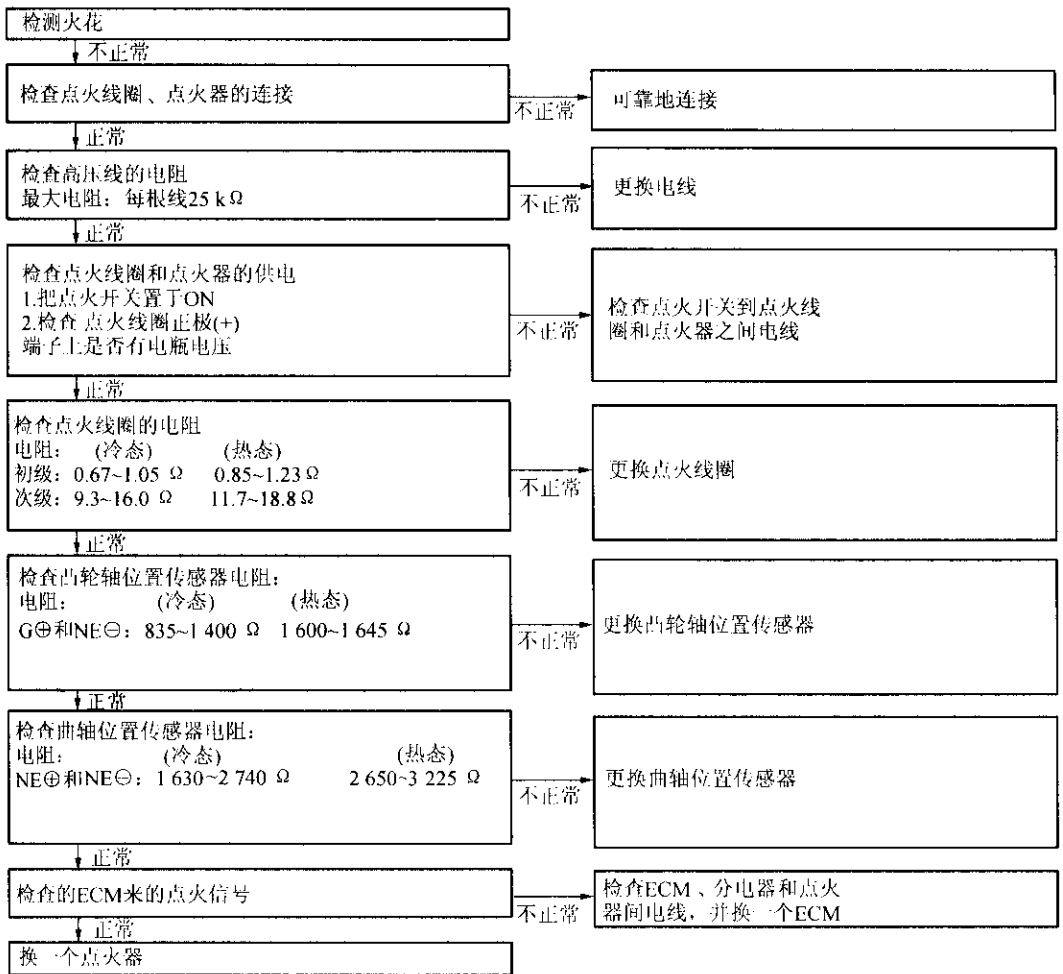
图 8-39 点火电路检测流程图
