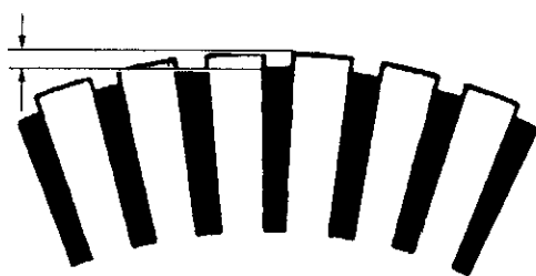
图 8-12 用锯片修正凹槽深度
