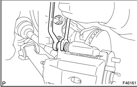
**37. INSTALL FRONT DISC BRAKE CYLINDER SUB-ASSY**
