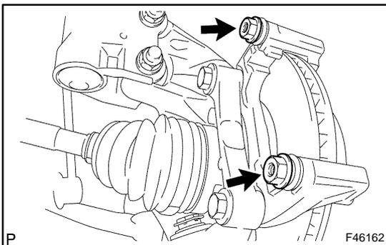
**32. INSTALL FRONT DISC BRAKE CYLINDER SLIDE PIN**
