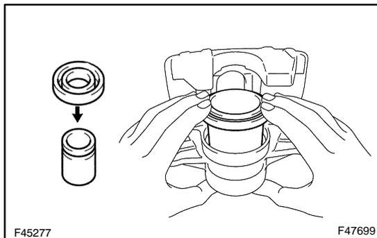
**28. INSTALL FRONT DISC BRAKE PISTON**
