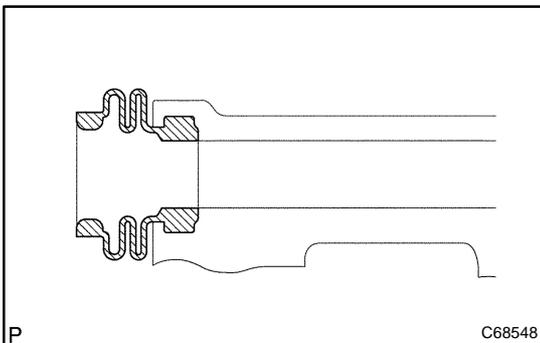
**31. INSTALL FRONT DISC BRAKE BUSH DUST BOOT**
