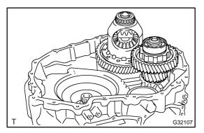
40. INSTALL DIFFERENTIAL DRIVE PINION
