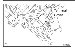
(d) Install the terminal cover shown in the illustration.
