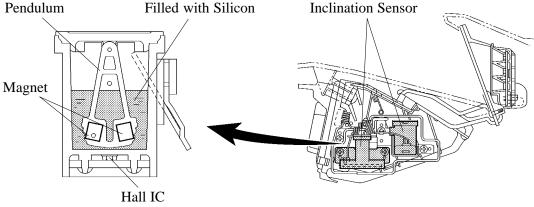
**Inclination Sensor Cross Section**
