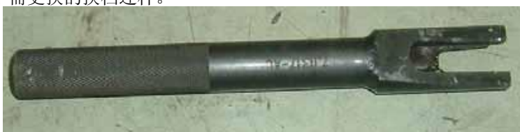
图 5：拆卸换挡连杆专用工具 ZX 0338E
