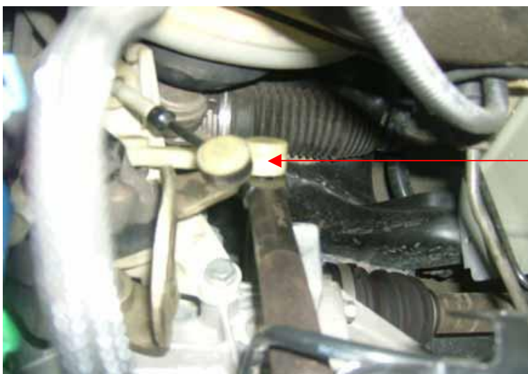
图 5：拆卸换挡连杆专用工具 ZX 0338E
