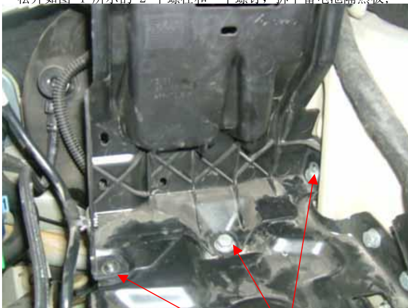
图 4：蓄电池隔热板的一个螺钉和 2 个螺栓
