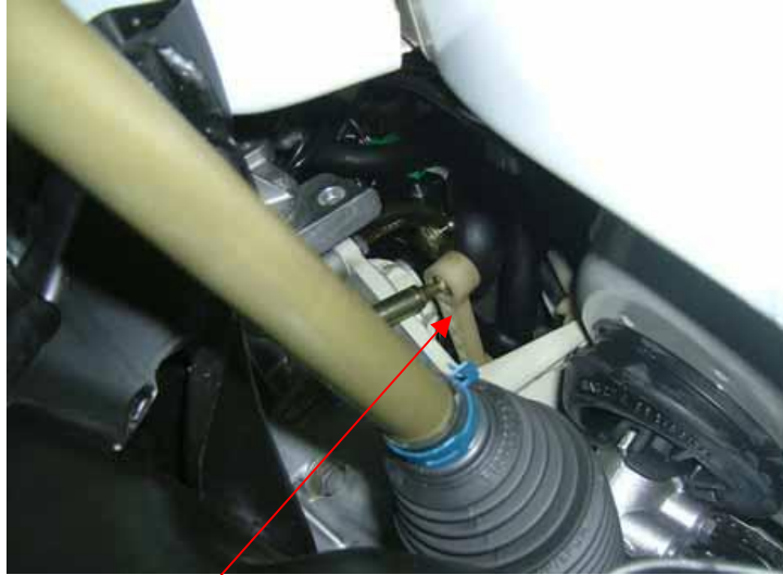
图 1：用手摸连杆的正面，判断是否需要更换
