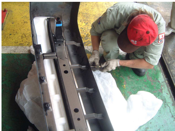
拆下加強板固定螺絲
