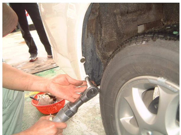
拆除保桿固定螺絲(三個)
